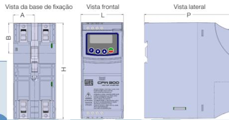
Figura 2: Dimensões do inversor para instalação mecânica
